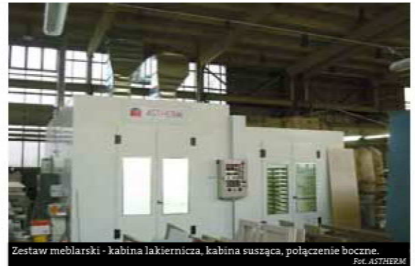
Zestaw kabin meblarskich - 2 kabiny lakiernicze, kabina susząca i strefa szlifierska. Fot. ASTHERM
