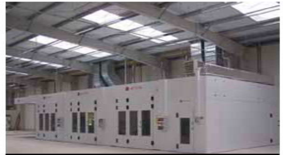
Zestaw kabin meblarskich - 2 kabiny lakiernicze, kabina susząca i strefa szlifierska. Fot. ASTHERM
